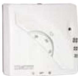
Elemento sensibile a membrana ad espansione di vapore. Manopola con limitazione del campo o blocco della regolazione alla temperatura impostata. È adatto per impianti di riscaldamento e/o condizionamento. Per la sua semplicità d'uso ed economicità può essere usato per l'azionamento di valvole di zona e per la regolazione compartimentata di aree delimitate. Disponibilità a realizzare, su richiesta del cliente, versione con segnalatore luminoso di funzionamento impianto o presenza alimentazione.
